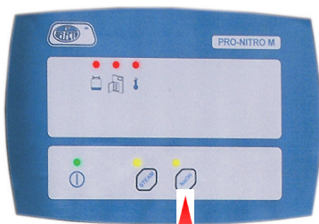
Adición manual del NaOH durante la destilación
