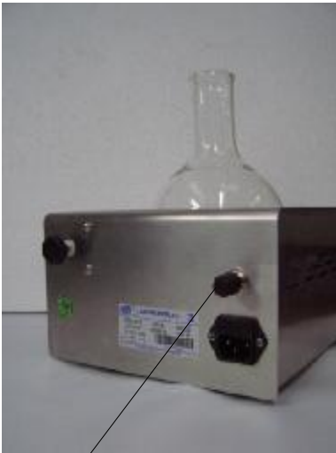
Fig 2. Localización del conector de la sonda de temperatura.
